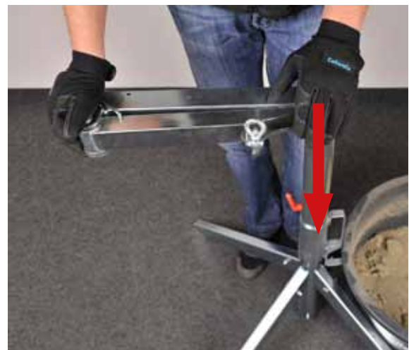
Schwenkarm entriegeln: von oben das Rundrohr etwas nach unten drücken
